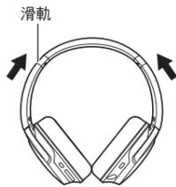
4 先將本產品L側機殼如右圖摺疊，再將充電端子所在處的R側機殼如圖示折疊。
