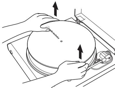
2. 移除轉盤並將轉盤翻面，然後取下舊皮帶。
