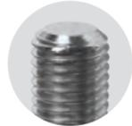
就連內六角螺絲也有我們的堅持。與線材的連接面沒有螺牙，光滑無比。除了不對導體造成損傷之外，還增加了接觸面積，達到更高的傳導效率。(部分製品例外)
