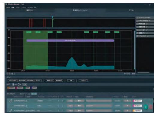
透過設置頻率情報與條件，計算出可用頻率以及通過裝置輸入進行規劃來分配給各個裝置。使用接收器掃描來確認現場頻率情況，以提供更穩定的工作環境。
