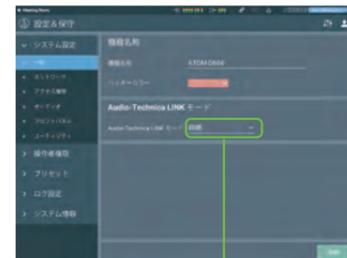
在「Audio-Technica LINK mode」下，將任一端的ATDM-0604設置為「主機」。
