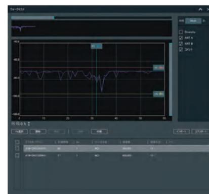
可在時間軸上實時顯示和記錄操作環境中的麥克風所發射的無線電波強度 (dBm)。同時顯示天線 A 和 B 以及 True-diver 的結果。用 X 軸和 Y 軸標記來表示準確數值。在現場可快速確認電波的覆蓋範圍。
